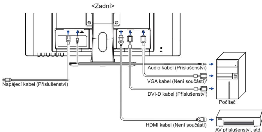
\* VGA kabel není součástí dodávky monitoru. Pokud používáte VGA kabel nízké kvality, může dojít k elektromagnetickému rušení. Obráťte se prosím na servisní středisko iiyama ve Vaší zemi, pokud se chcete připojit monitor přes VGA vstup.
