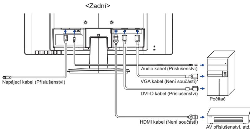
\* VGA kabel není součástí dodávky monitoru. Pokud používáte VGA kabel nízké kvality, může dojít k elektromagnetickému rušení. Obratěte se prosím na servisní středisko iiyama ve Vaší zemi, pokud se chcete připojit monitor přes VGA vstup.
