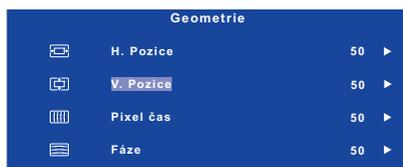
Potom pomocí tlačítek ◀ / ▶ pro změnu nastavení vertikální polohy. Vertikální poloha displeje by se měla odpovídajícím způsobem měnit, když děláte to.
