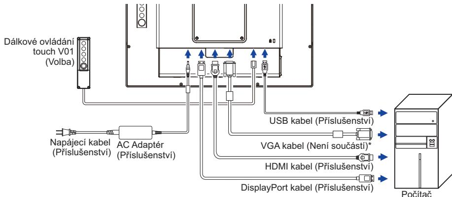
\* VGA kabel není součástí dodávky monitoru. Pokud používáte VGA kabel nízké kvality, může dojít k elektromagnetickému rušení. Obraťte se prosím na servisní středisko iiyama ve Vaší zemi, pokud se chcete připojit monitor přes VGA vstup.
