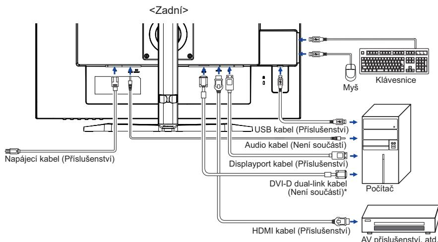
\* DVI dual-link kabel není součástí dodávky monitoru. Pokud používáte DVI dual-link kabel nízké kvality, může dojít k elektromagnetickému rušení. Obraťte se prosím na servisní středisko iiyama ve Vaší zemi, pokud se chcete připojit monitor přes DVI vstup.
