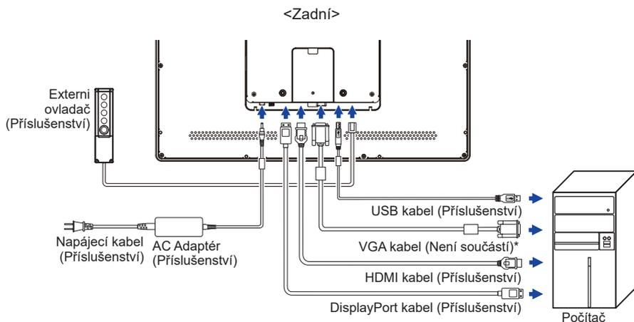
\* VGA kabel není součástí dodávky monitoru. Pokud používáte VGA kabel nízké kvality, může dojít k elektromagnetického rušení. Obrat'te se prosím na servisní středisko iiyama ve Vaší zemi, pokud se chcete připojit monitor přes VGA vstup.
