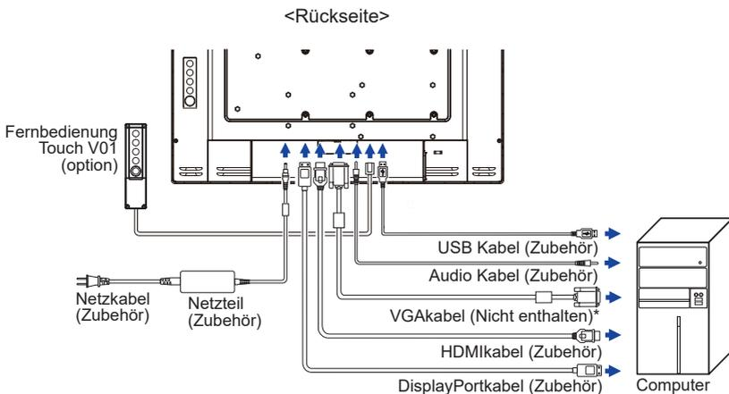
\* Das VGAKabel ist nicht im Lieferumfang enthalten. Wenn ein qualitativ niedriges VGAKabel verwendet wird, kann dies elektromagnetische Störungen verursachen. Bitte kontaktieren Sie das iiyama Support Center in Ihrem Land, wenn Sie den Monitor über den VGA-Eingang anschließen wollen.
