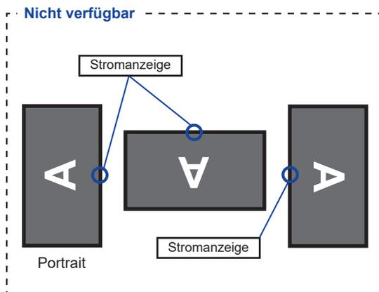
Dieser Monitor kann nur im Querformat verwendet werden. Drehen oder betreiben Sie den Monitor nicht in einer anderen Ausrichtung als im Querformat.
