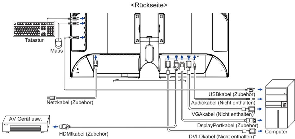
\* Das Kabel ist nicht im Lieferumfang enthalten. Wenn ein qualitativ niedriges Kabel verwendet wird, kann dies elektromagnetische Störungen verursachen. Bitte kontaktieren Sie das iiyama Support Center in Ihrem Land, wenn Sie den Monitor über den VGA oder DVI-Eingang anschließen wollen.
