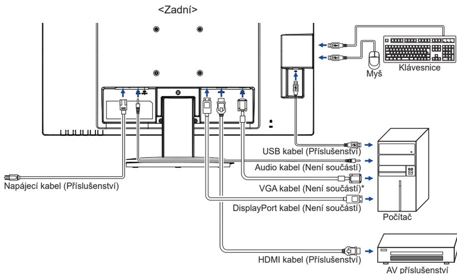
\* VGA kabel není součástí dodávky monitoru. Pokud používáte VGA kabel nízké kvality, může dojít k elektromagnetickému rušení. Obrat'te se prosím na servisní středisko iiyama ve Vaší zemi, pokud se chcete připojit monitor přes VGA vstup.
