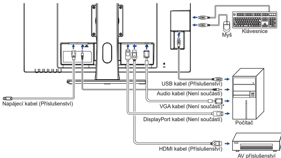
\* VGA kabel není součástí dodávky monitoru. Pokud používáte VGA kabel nízké kvality, může dojít k elektromagnetickému rušení. obraťte se prosím na servisní středisko iiyama ve Vaší zemi, pokud se chcete připojit monitor přes VGA vstup.
