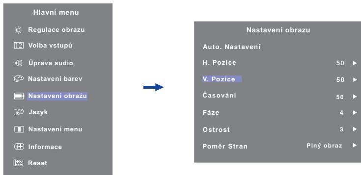
Potom pomocí tlačítek **◀ / ▶** pro změnu nastavení vertikální polohy. Vertikální poloha displeje by se měla odpovídajícím způsobem měnit, když děláte to.
