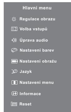
Například pro korekci svislé polohy zvolte položku Menu Nastavení obrazu a poté stiskněte tlačítko ENTER. Pak vyberte V. Pozice pomocí tlačítka **◀ / ▶**. Stránka nastavení se objeví po stisknutí tlačítka ENTER.
