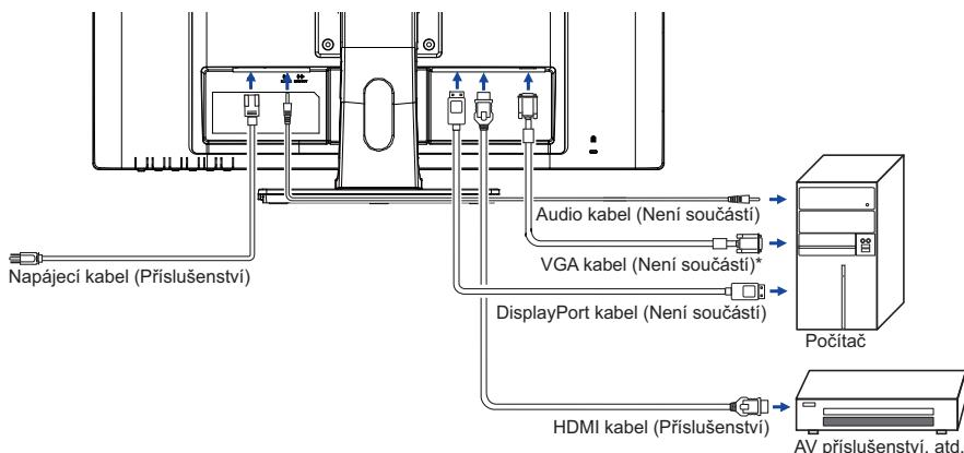
\* VGA kabel není součástí dodávky monitoru. Pokud používáte VGA kabel nízké kvality, může dojít k elektromagnetickému rušení. Obraťte se prosím na servisní středisko iiyama ve Vaší zemi, pokud se chcete připojit monitor přes VGA vstup.
