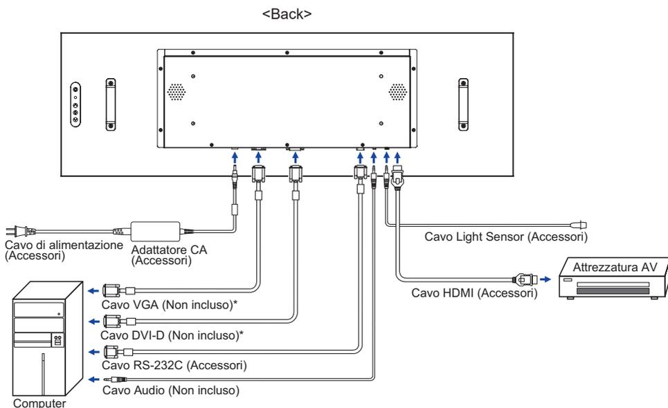
\* Il cavo non è fornito con il monitor. Se usate un cavo di scarsa qualità si potrebbero avere interferenze elettromagnetiche. Si prega di contattare il Centro di Supporto di Iiyama nel vostro paese se si desidera collegare il monitor tramite l'ingresso VGA o DVI.
