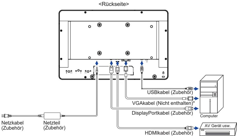
\* Das VGA Kabel ist nicht im Lieferumfang enthalten. Wenn ein Qualität niedriges VGA Kabel verwendet wird, kann dieses elektromagnetischen Störungen verursachen. Bitte kontaktieren Sie das iiyama Support Center in Ihrem Land, wenn Sie den Monitor über den VGA-Eingang anschließen wollen.
