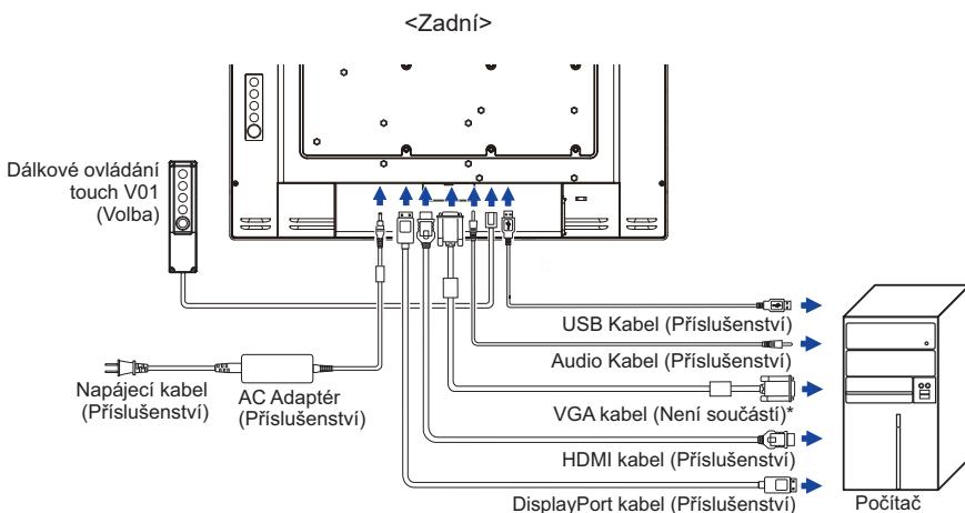
\* VGA kabel není součástí dodávky monitoru. Pokud používáte VGA kabel nízké kvality, může dojít k elektromagnetického rušení. Obratěte se prosím na servisní středisko iiyama ve Vaší zemi, pokud se chcete připojit monitor přes VGA vstup.
