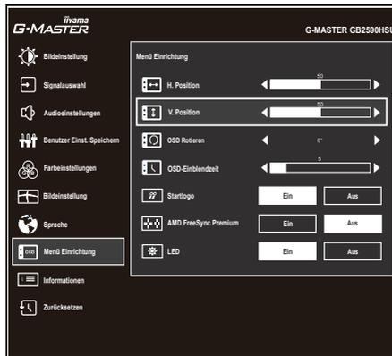
Drücken Sie die Taste ENTER und schließlich die Taste EXIT, um die Bildschirmanzeige-funktion zu schließen. Alle Änderungen werden im Speicher gespeichert.
