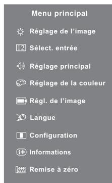
Par exemple, pour corriger la position verticale OSD, sélectionnez l'élément Configuration du Menu, puis appuyez la touche ENTER. Puis, sélectionnez Position OSD en utilisant les touches ◀/▶. Une page d'ajustement apparaît après l'appui sur la touche ENTER. Puis, sélectionnez Position V. en utilisant les touches ◀/▶.
