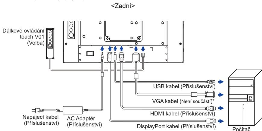
\* VGA kabel není součástí dodávky monitoru. Pokud používáte VGA kabel nízké kvality, může dojít k elektromagnetickému rušení. Obratě se prosím na servisní středisko iiyama ve Vaší zemi, pokud se chcete připojit monitor přes VGA vstup.
