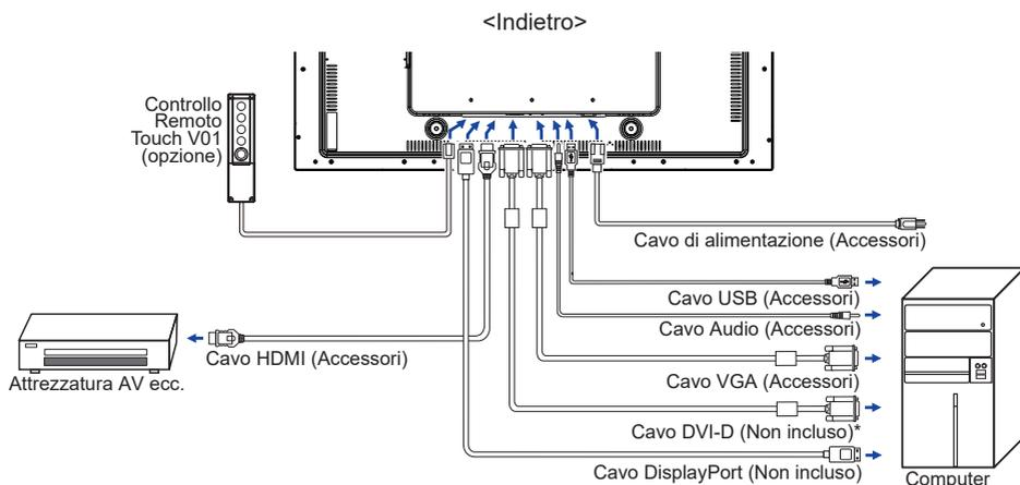
\* Il cavo DVI-D non è fornito con il monitor. Se usate un cavo DVI-D di scarsa qualità si potrebbero avere interferenze elettromagnetiche. Si prega di contattare il Centro di Supporto di Iiyama nel vostro paese se si desidera collegare il monitor tramite l'ingresso DVI.
