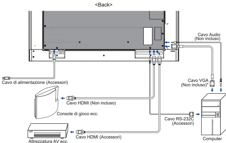
\* Il cavo VGA non è fornito con il monitor. Se usate un cavo VGA di scarsa qualità si potrebbero avere interferenze elettromagnetiche. Si prega di contattare il Centro di Supporto di Iiyama nel vostro paese se si desidera collegare il monitor tramite l'ingresso VGA.
