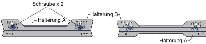
② Befestigen Sie die L-Halterung (①) an der Rückseite der Aussparung an dem der Monitor befestigt werden soll und befestigen Sie diese mit den Schrauben.
