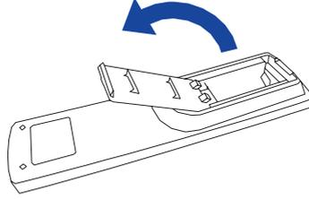
② Artı ve eksi bağlantı noktalarına göre (uzaktan kumandada gösterildiği şekilde) iki AAA pilini hizalayın ve yerleştirin.
