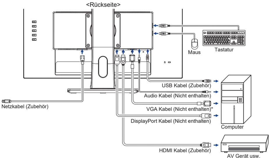
\* Das VGA Kabel ist nicht im Lieferumfang enthalten. Wenn ein qualitativ niedriges VGA Kabel verwendet wird, kann dieses elektromagnetischen Störungen verursachen. Bitte kontaktieren Sie das iiyama Support Center in Ihrem Land, wenn Sie den Monitor über den VGA-Eingang anschließen wollen.
